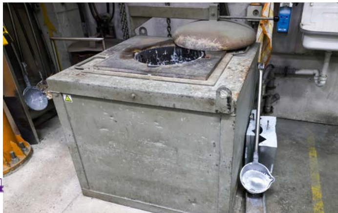
In diesem Schmelzofen wird die Zink-Alu-Legierung Zamak geschmolzen
