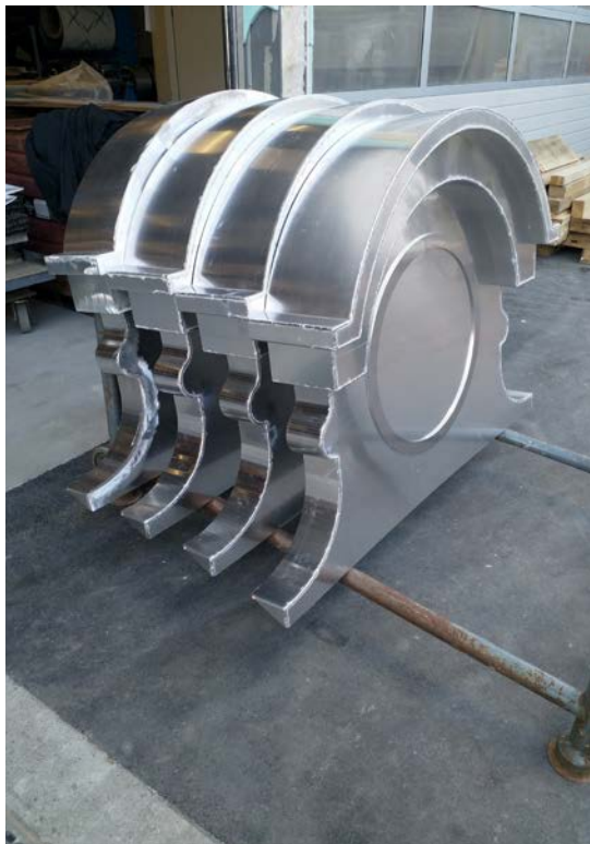
Einfassung der Ochsenaugen aus Aluminium
