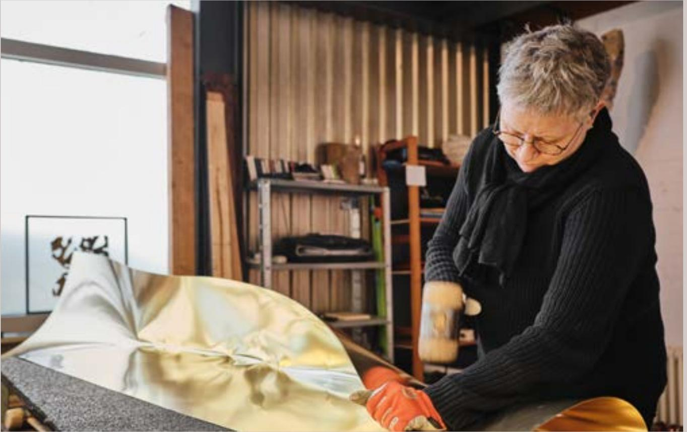
geformt, gestaucht und verdichtet. In den letzten Arbeitsschritten wird durch Abflammen nicht nur die Oberfläche eingefärbt, sondern es wird auch eine
